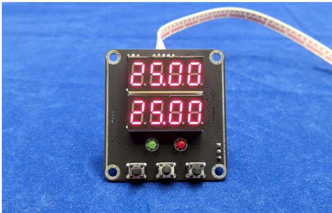
我司的产品的一个最主要的特点就是产品的参数可以设置。大多数情况下，可以通过电脑连接产品的串口，用上位机软件进行设置。
